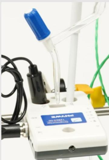
Рис.2 Размещение бюретки
